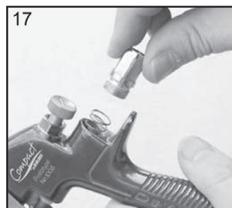
17. Vuelva a colocar el muelle de la válvula y vuelva a colocar en el alojamiento (10).
