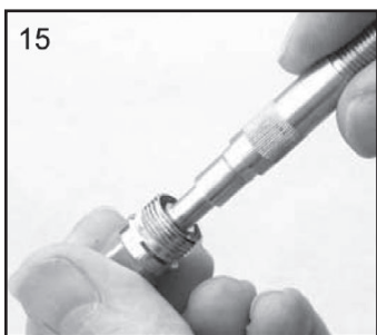
15. Coloque la junta en el alojamiento (10).
