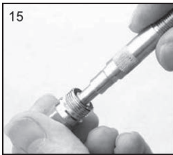
15. Coloque la junta en el alojamiento (10).
