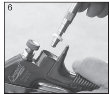
6. Retire el asiento de la válvula.
